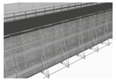
Saubere, wasserdichte Arbeitsflächen mit Aufbordung. Schutzwand aus Netz, Vlies oder Holz.
